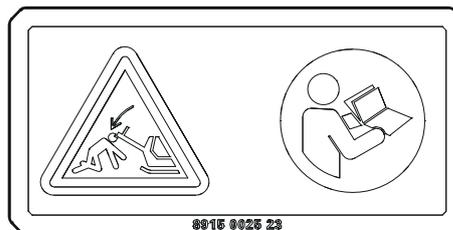
В поднятом состоянии рукоятка должны быть заблокирована. См. инструкцию по эксплуатации.
